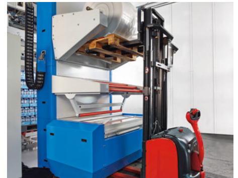
Schneller Folienrollenwechsel per Gabelstapler – einfache Kontrolle per BEUMER Group HMI
