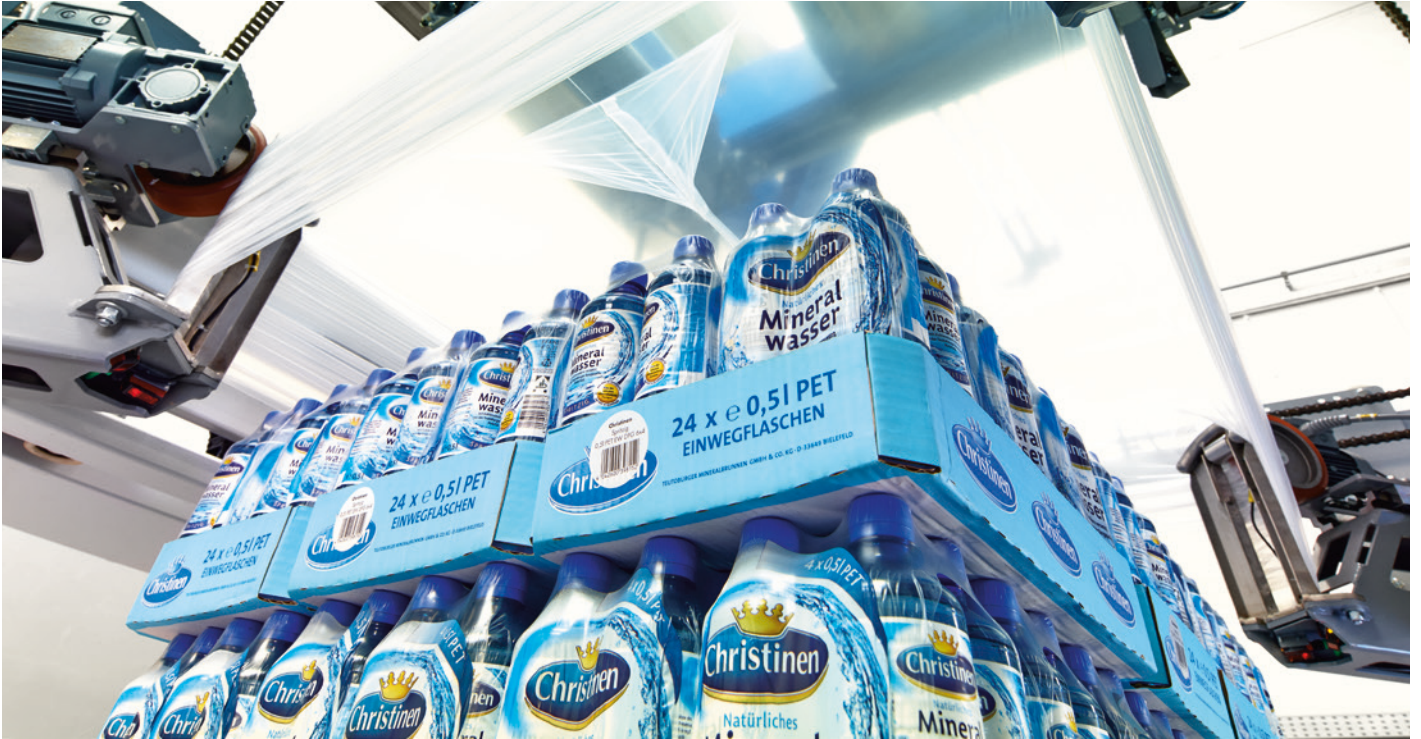
Aufspannen der Follenhaube und Übergabe in die Reffleinrichtung
