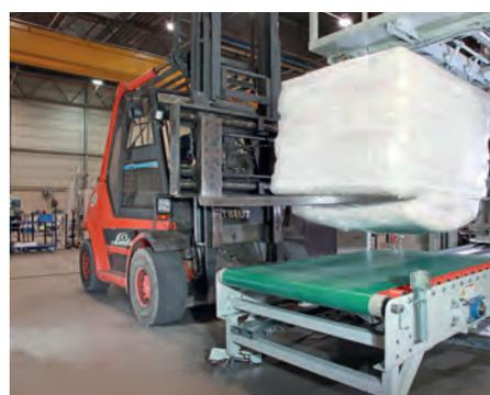
BEUMER paketpac®-Maschinen verpacken Sackgüter mit verschiedenen Folienverfahren, sodass diese auch ohne Paletten sicher gelagert und transportiert werden können.
