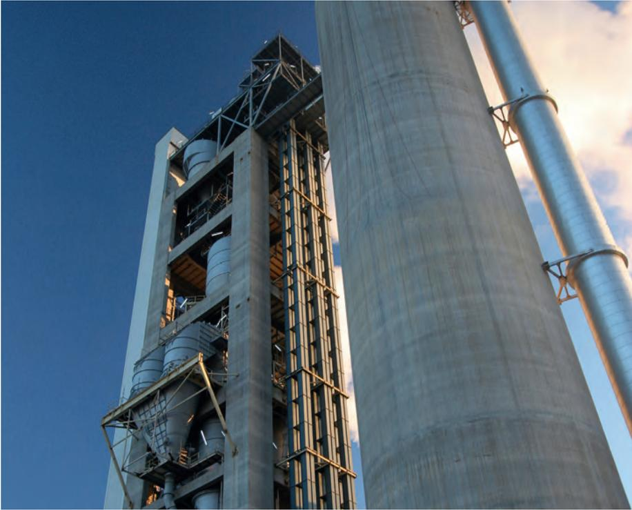
BEUMER Becherwerke eignen sich zur mechanischen Senkrechtförderung von Schüttgütern, zum Beispiel in einem Zementwerk.
