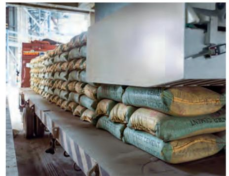
*Der BEUMER autopac® ist ein vollautomatisches Verlade- und Palettiersystem für abgesackte Materialien.*
