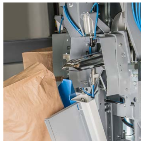
Optimierter Kipprahmen für punktgenauen Sackabwurf
