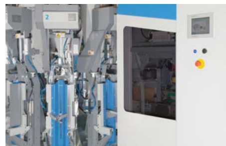
Vollautomatischer Hochleistungs-Sackaufstecker für erhöhte Verfügbarkeit
