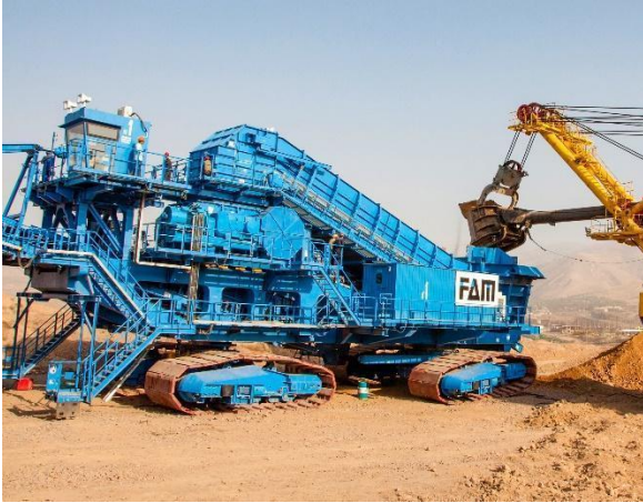
Bild 7: FAM In-pit Brechanlage auf Raupen (Quelle: BEUMER Group/FAM)
