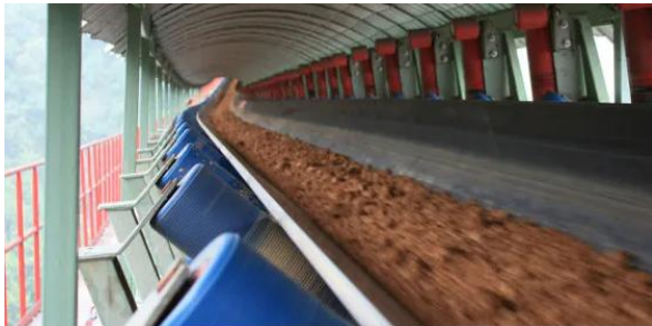
Bild 2: Offene Muldengurtförderer werden verwendet, um Schüttgüter über große Entfernungen und durch schwieriges Gelände zu transportieren (Quelle: BEUMER Group)
