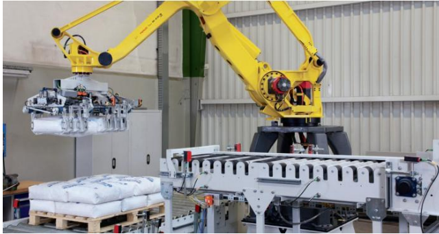
Bild 8: BEUMER robotpac ermöglicht die zuverlässige, sichere und automatisierte Palettierung von Säcken, Kartons, Eimern und Kanistern (Quelle: BEUMER Group)
