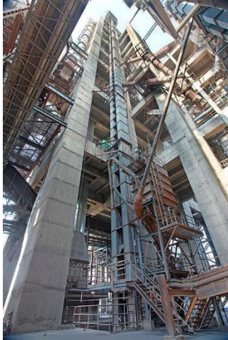
Bild 1: BEUMER Gurtbecherwerke vom Typ HGBW fördern das Material bis über 200 m (Quelle: BEUMER Group)
