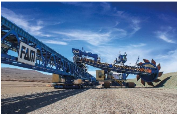
Bild 2: FAM Förderbrücke auf Raupen mit Bandschleifenwagen (Quelle: BEUMER Group/FAM)
