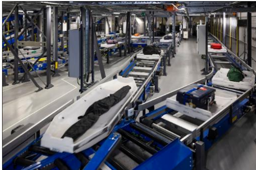
Bild 2: CrisBag – Behälterbasiertes, unabhängiges Gepäcktransportsystem (Quelle: BEUMER Group)
