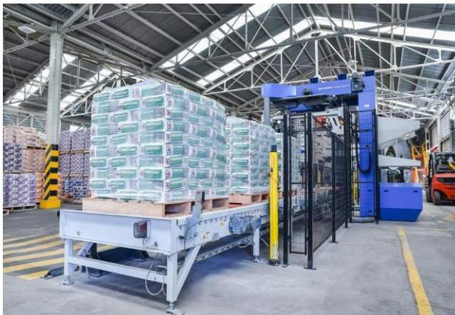
Bild 9: BEUMER stretch hood A bietet höchste Ladungsstabilität durch die Kombination von vertikalen und horizontalen Rückstellkräften der Folie (Quelle: BEUMER Group)
