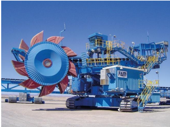
Bild 1: FAM Schaufelradbagger Rücklader (Quelle: BEUMER Group/FAM)
