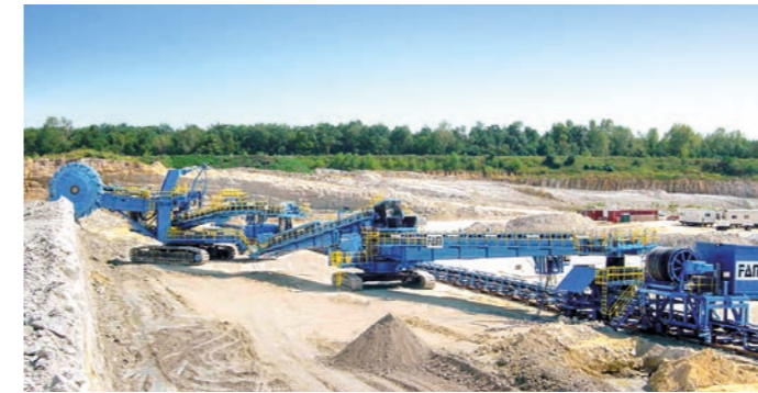
Bandwagen auf Raupen BW1200.22/28R, Mergel 2300 t/h, 1600 m 3 /h, USA
