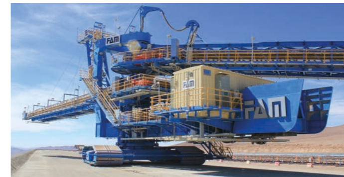
Absetzer auf Raupen ST3500.40, Gelaugtes Kupfererz 3500 t/h, 1950 m 3 /h, Chile
