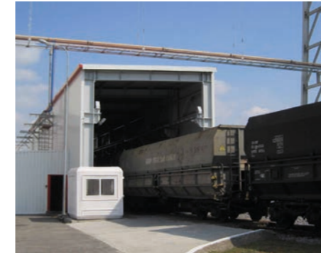
Waggonladung WUL9.200, Entstaubung, Petrolkoks 200 t/h, Rumänien
