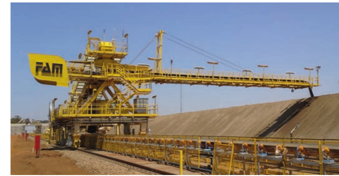
Absetzer ST450.27, Auslegerlänge 27 m, Niobiumerz 450 t/h, Brasilien
