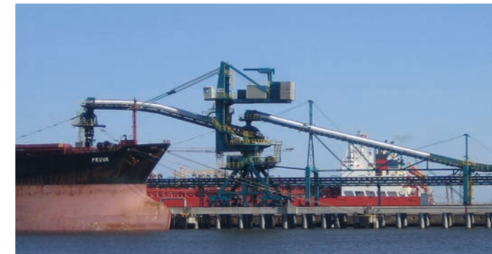
Schiffsbelader SL3000.395X, verfahrbar, schwenkbar, Beladung: Teleskoprutsche, Steinkohle 3000 t/h, Lettland
