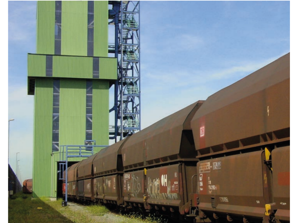
Waggonladung WUL9.200, Entstaubung, Petrolkoks 200 t/h, Rumänien
