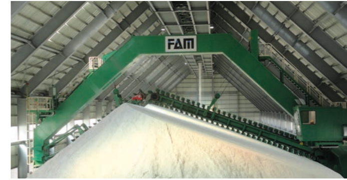
Portalkrater KP342.27, Spurweite 27 m, Rohsalz 340 t/h, Bolivien
