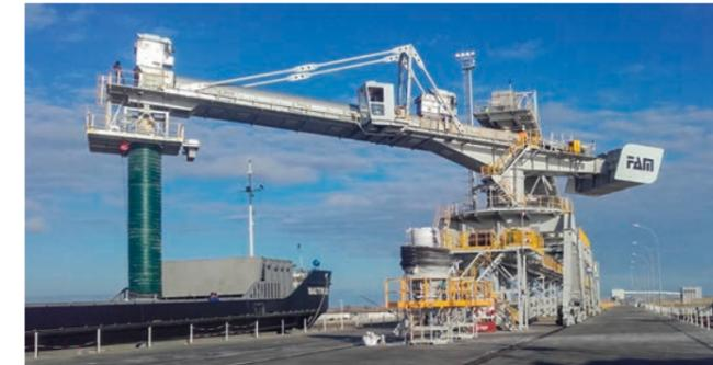
Schiffsbelader SL1200.31.D.H. verfahrbar, Beladung mit Kaskadenrutsche, Harnstoff 1200 t/h, Turkmenistan
