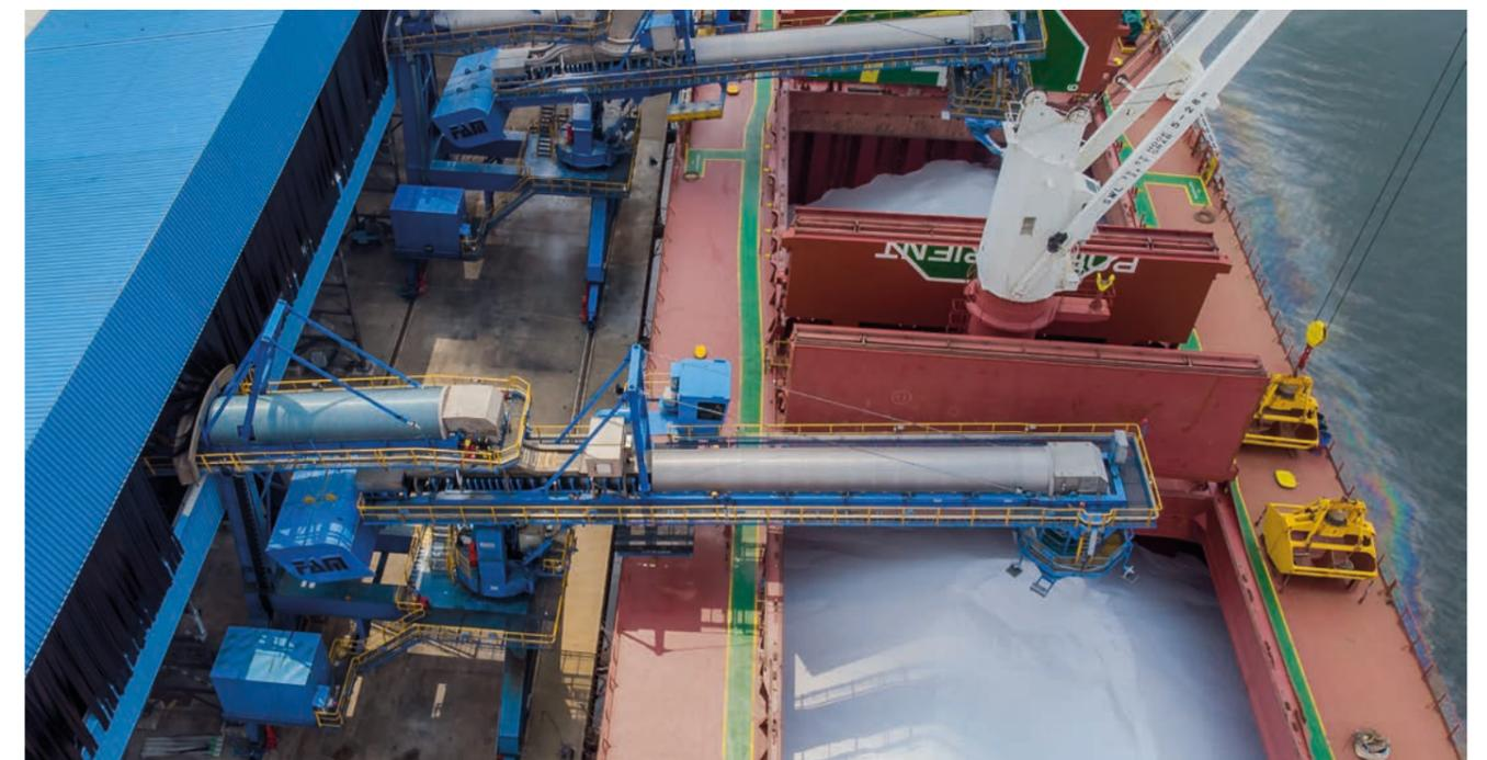
Schiffsbelader SL990.24, verfahrbar, Harnstoff 990 t/h, Nigeria
