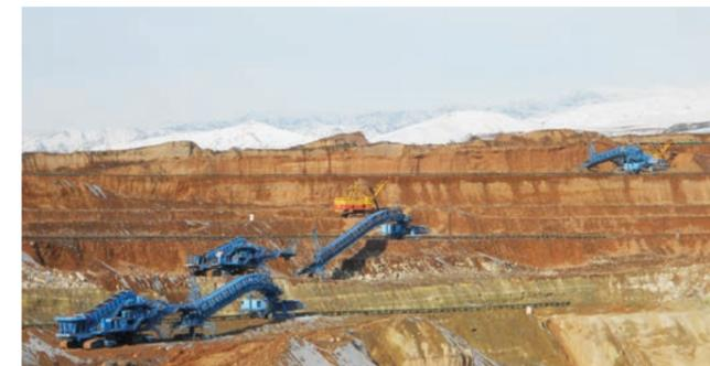
In-Pit Aufbereitungsanlage, Abraum 5250 t/h, Kohle 800 t/h, Usbekistan
