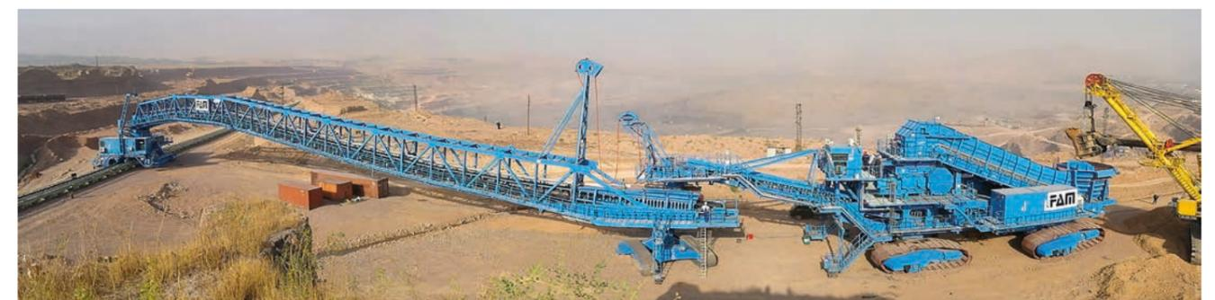
In-Pit Aufbereitungsanlage, Abraum 5250 t/h, Kohle 800 t/h, Usbekistan
