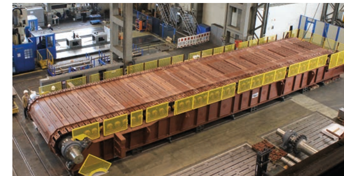
Plattenband AF3400x22, Ölsand 3x7260 t/h, Kanada
