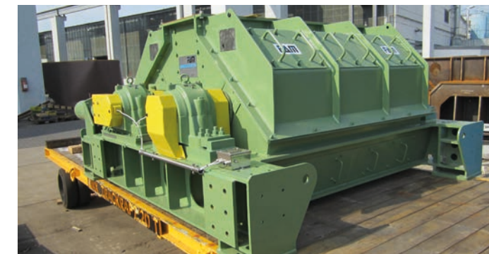
Zweiwalzenbrecher ZWB0815MS-H, Kalk 130 t/h, Deutschland
