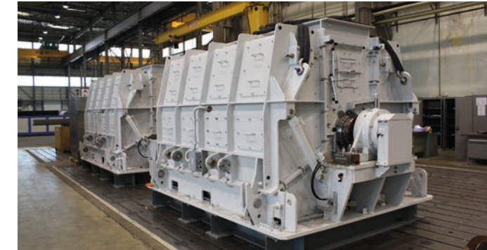
Prall-Hammermühle PHM1628MVD, Kohle 650 t/h, China
