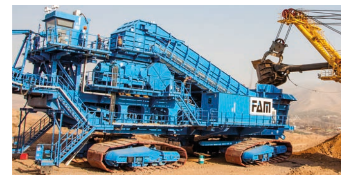
In-Pit Brechanlage FZWB2025 auf Raupen, Abraum 5250 t/h, Usbekistan
