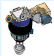
Mit dem BEUMER Losebeladekopf können Silofahrzeuge schnell und staubfrei beladen werden. Er ist nach dem Doppelwandsystem konstruiert, d. h. Material-einlauf und Entstaubungssystem sind voneinander getrennt. Der Losebeladekopf muss an ein Entstaubungsluftnetz angeschlossen sein. Die Hubvorrichtung ist eine Motor- oder Handseilwinde. Die Materialzufuhr muss dosiert erfolgen. Für die Bedienung wird ein Operator Panel verwendet. Beim Aufsetzen auf einen Silo dom senkt sich der Verschlusskegel des
