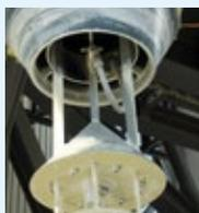
Die Füllstandsmelder haben die Aufgabe, die Materialzufuhr zum Losebeladekopf bei gefülltem Fahrzeug zuverlässig abzuschalten. Dazu werden je nach spezifischer Eigenschaft des Materials verschiedene Füllstandsmelder eingesetzt. Kriterien für die Auswahl des richtigen Schalters
