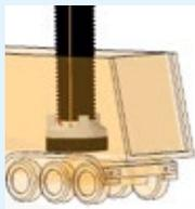
Für die staubfreie Beladung offener Fahrzeuge stehen verschiedene Teleskopbeladeanlagen zur Verfügung. Bei Ladebeginn wird der Losebeladekopf bis auf den Fahrzeugboden abgesenkt und die Materialzufuhr eingeschaltet. Das Hochziehen wird automatisch durch einen Füllstandschalter in der unteren Entstaubungshaube ausgelöst, der durch das aufsteigende Material bedämpft wird.
