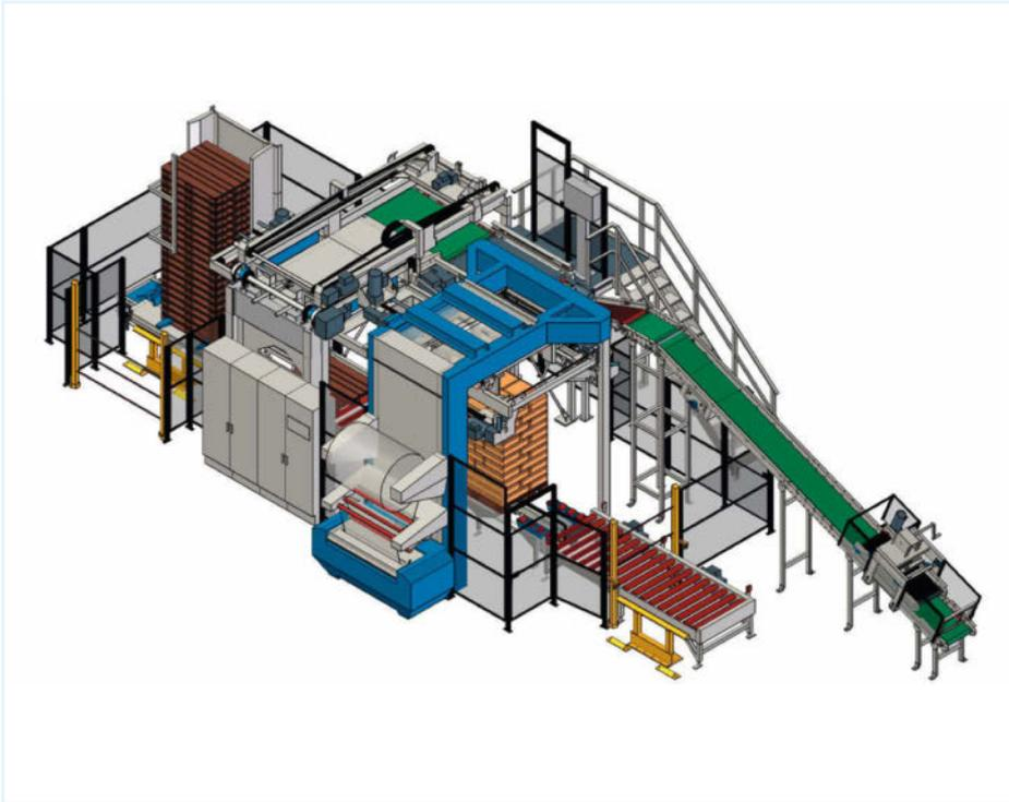
Kompakte, platzsparende Anlage für die Palettierung und Stretchhaubenverpackung
