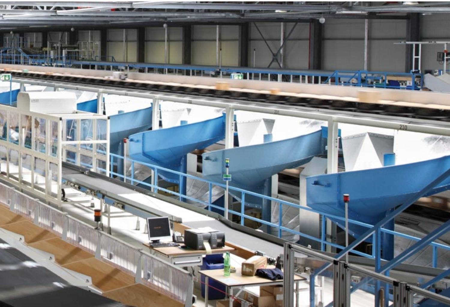
Bewährte Technologie und innovatives Design erfüllen diese Ziele beim BG Sorter® Compact CB, einem Hochleistungs-Loopsorter mit Quergurtförderern, der großen Durchsatz und hohe Sortiergenauigkeit in einem einzigen Prozess vereint.
