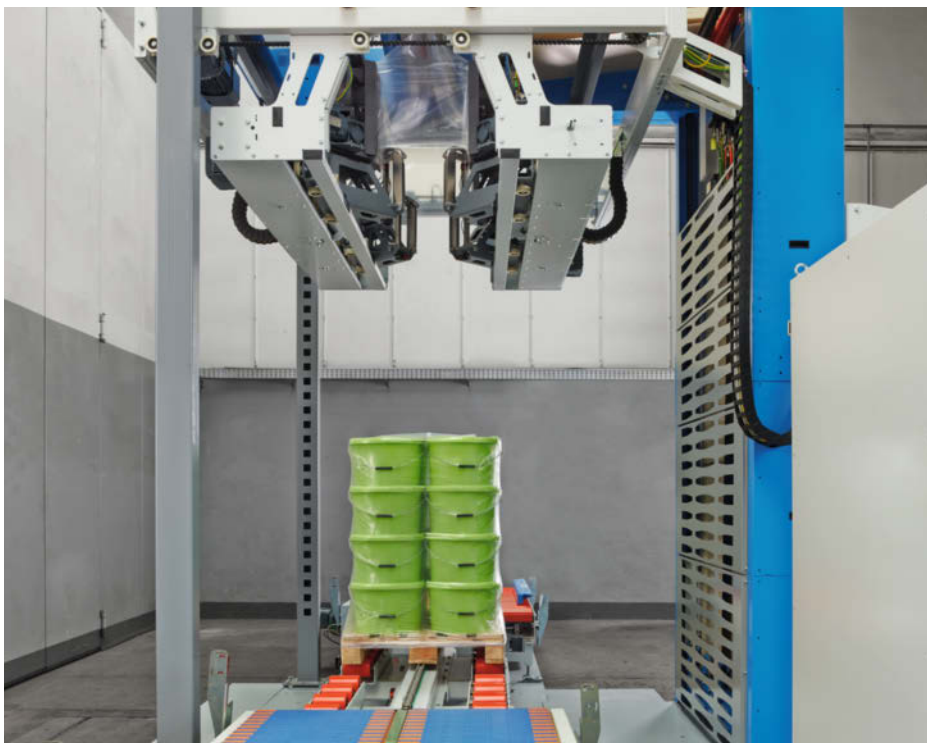
Unterschiedliche Arten von Packgütern werden durch die wasserdichte Folienhaube geschützt.
