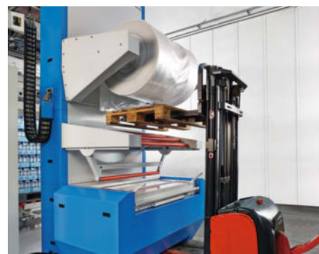
Die Folienrolle kann mit wenigen Handgriffen und ohne Werkzeug gewechselt werden.
