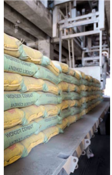
Dank der Kalibrierung der Lagen direkt auf dem LKW können die Säcke gleichmäßig gestapelt werden, dies garantiert einen sicheren Transport.
