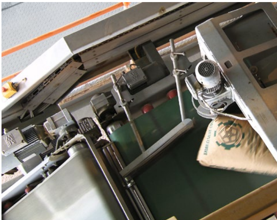
Die Stabdrehvorrichtung – hier in einem BEUMER autopac® 3000 bei Saudi Cement Company, Hofuf, Saudi-Arabien – positioniert die Säcke nach dem gewählten Muster.
