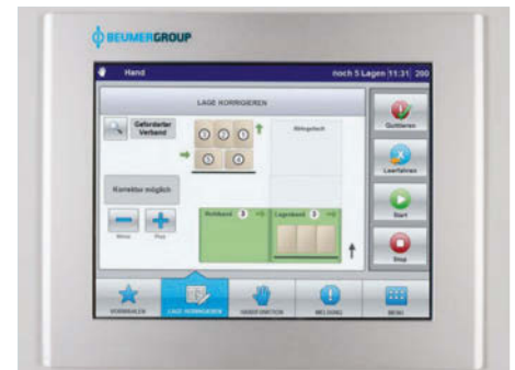
Bedienführung mit Grafiken und Schritt-für-Schritt-Anweisungen, z. B. bei Sackkorrekturen am BEUMER paletpac®
