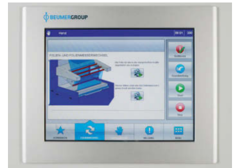
Unterstützung des Bedieners mithilfe von Videosequenzen, z. B. beim Folienrollenwechsel am BEUMER stretch hood®
