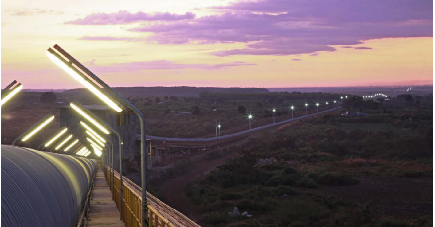
Die offenen BEUMER Muldengurtförderer sorgen für große Massenströme bei allen Produkten.
