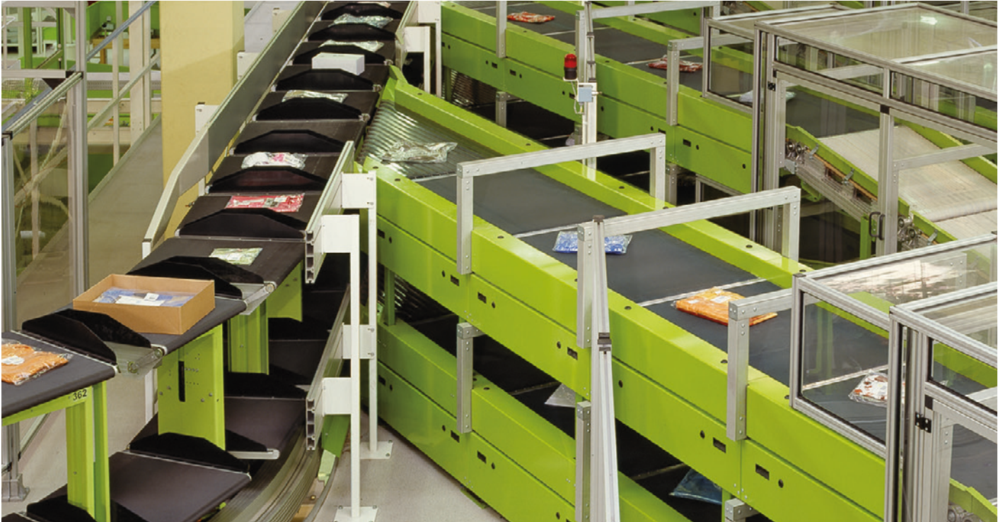
BEUMER Belt Tray Sorter für die effiziente und schonende Sortierung und Verteilung unterschiedlichster Waren
