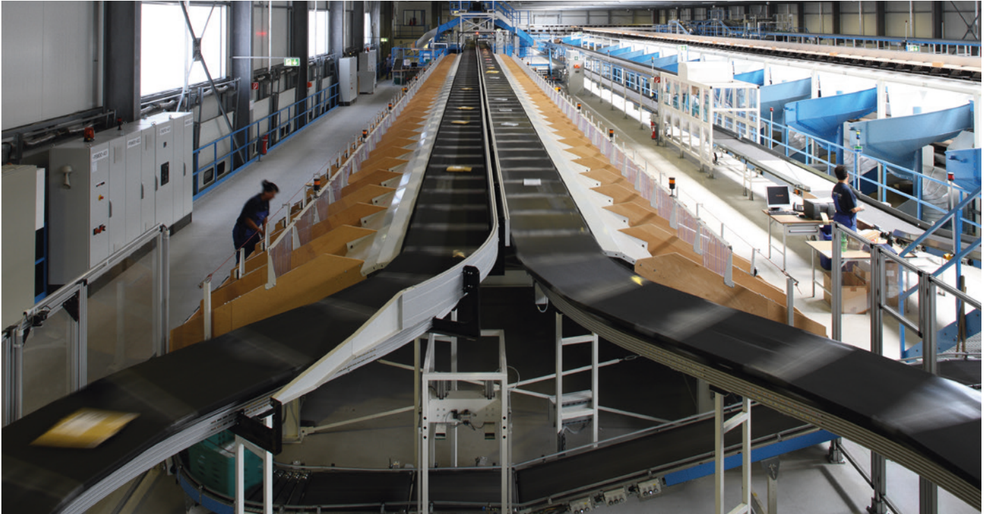
Sorterrahmen aus stranggepressten Aluminiumprofilen mit integrierten Fahrschienen
