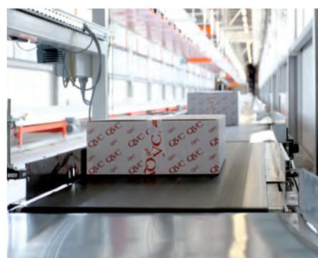
In Hückelhoven war die BEUMER Sortier- und Verteilanlage innerhalb von nur elf Monaten voll einsatzbereit: zwei elektromotorisch angetriebene Paketsorter und ein Kleingutsorter. Sie sind optimal auf die unterschiedlichen Anforderungen der Sendungen abgestimmt.
