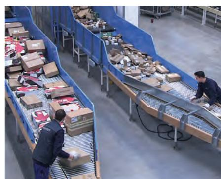
Im Hermes Logistikzentrum Friedewald in Hessen sorgt ein BEUMER Großstücksorter dafür, dass auch besonders große und schwere Sendungen zuverlässig weitergeleitet und verteilt werden. Alle anderen Packstücke werden über zwei BEUMER Paketsorter schnell und sicher abgewickelt.
